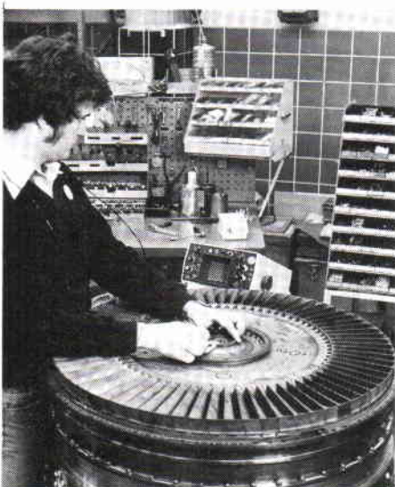
Kontrollingenjör Peder Wickström, FFV-U motoravdelning i Arboga, kontrollerar bulthål i en HT-turbinskiva för RM 6 med induktiv provning. En roterande givare ger besked om det är felfritt, eller... Foto Hans Hedin.
