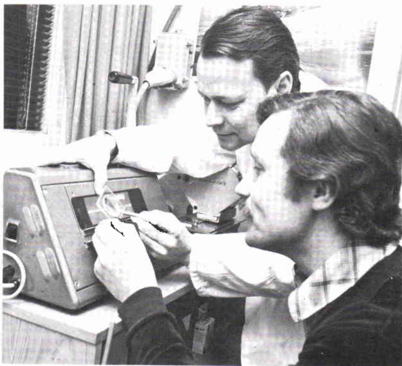
Lars Eriksson, FFV-U Östersund, tv lär sig bedöma röntgenradiogram av ett svetsprov. Läraren Jan Svensson, materiallab, undervisar. Foto Niklas Forslind.
